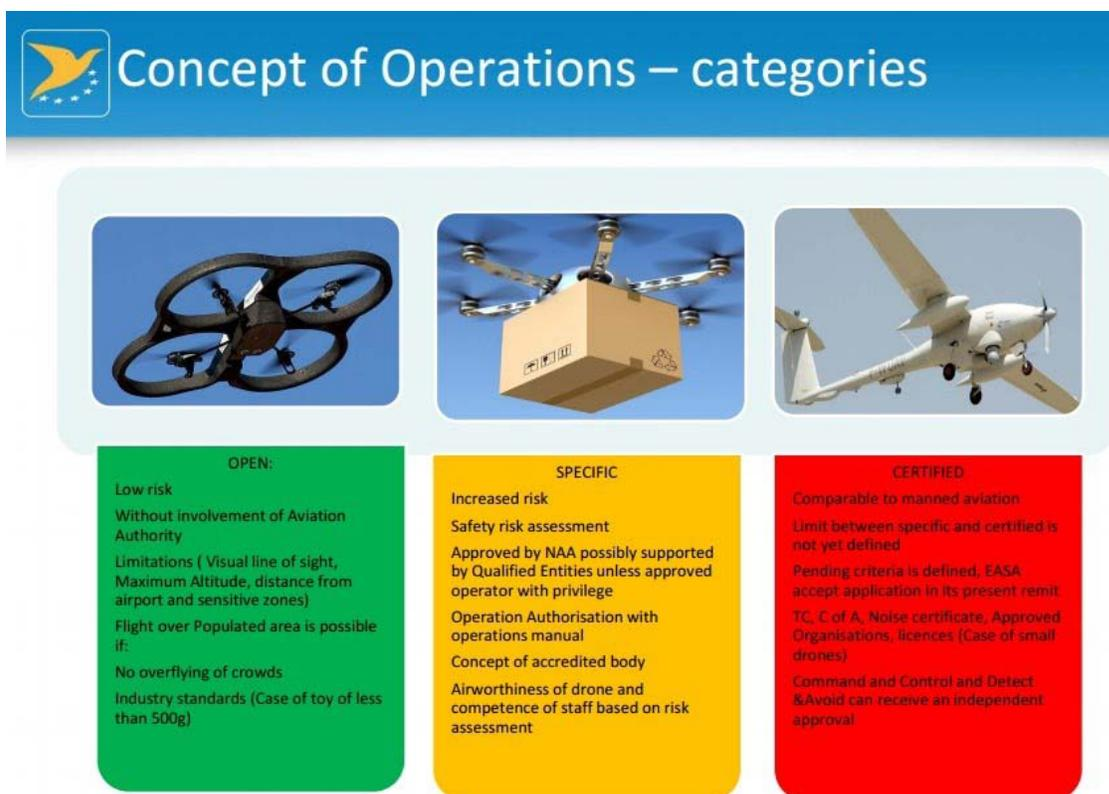
*Ilustración 11 Concept of Operations for Drones*
